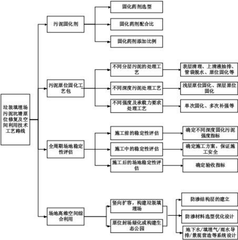
图 1 垃圾填埋场污泥坑塘原位修复及空间利用技术工艺路线
